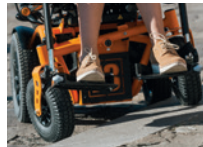
Grande capacité de franchissement grâce à son palonnier avant articulé.
