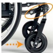
Roues avant 6" et fourche 3 points d'ancrage pour + de rigidité
